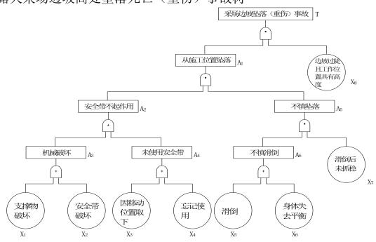
图 3.3-1 采场边坡高处坠落死亡(重伤)事故树
