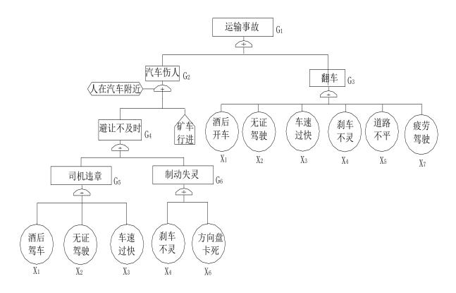
图 3.2-1 汽车运输事故的事故树图
